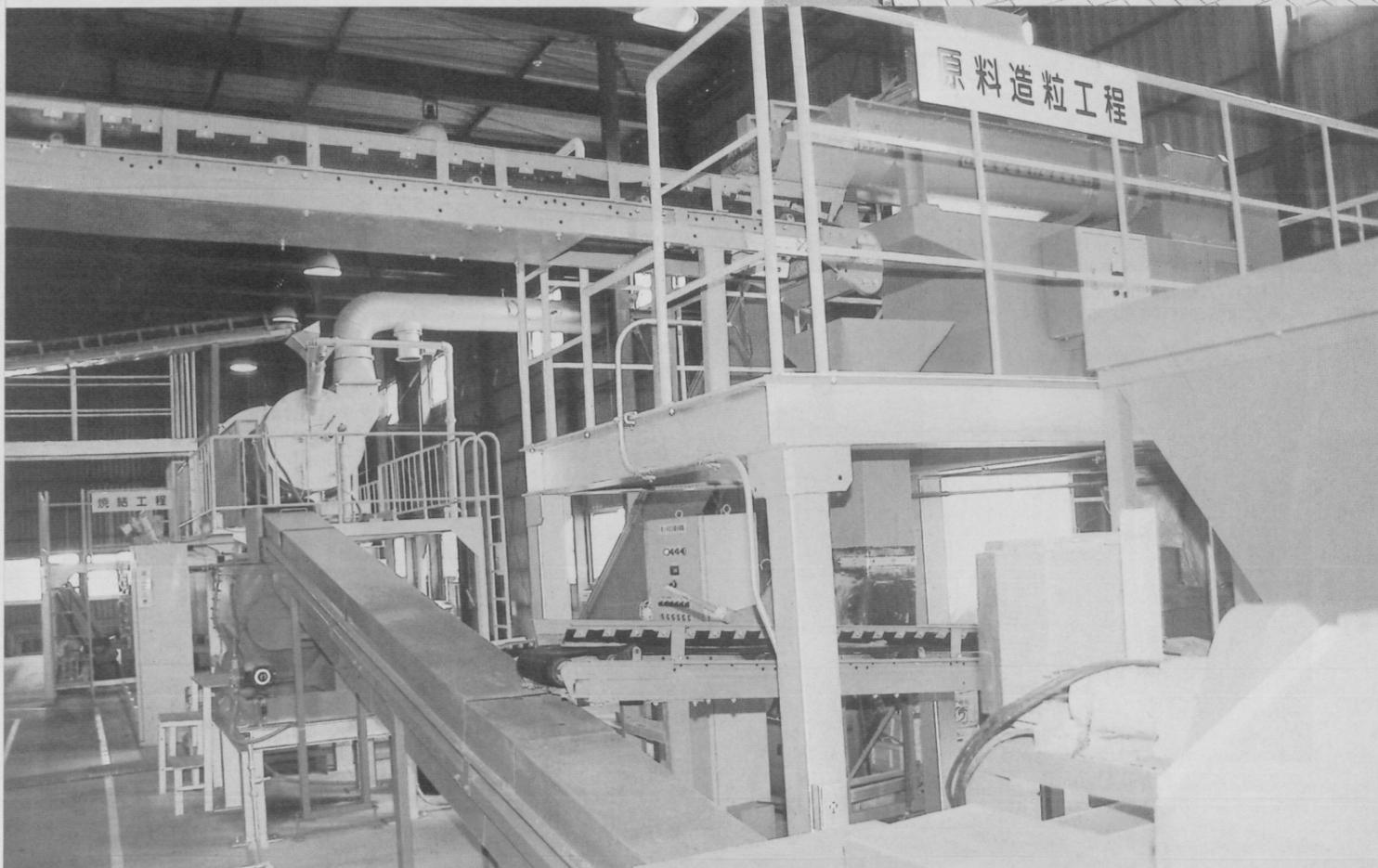
ごみの焼却灰を利用した、透水性ブロックの実験工場。実用化に成功し、全国で初めて国の補助を受けて、本格的な生産工場が建設されることになりました
