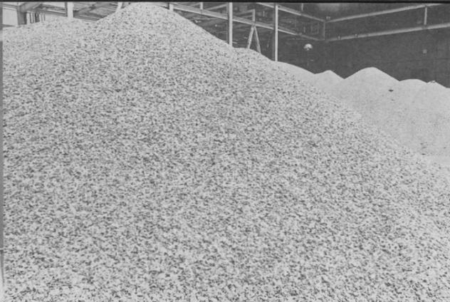
3種類の大きさに分けて製造され、コンクリート骨材などに利用されています
