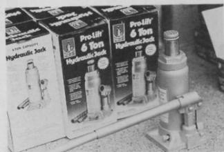
倒壊家屋などからの救出に使用する油圧ジャッキ。6トンの物を持ち上げることができます
