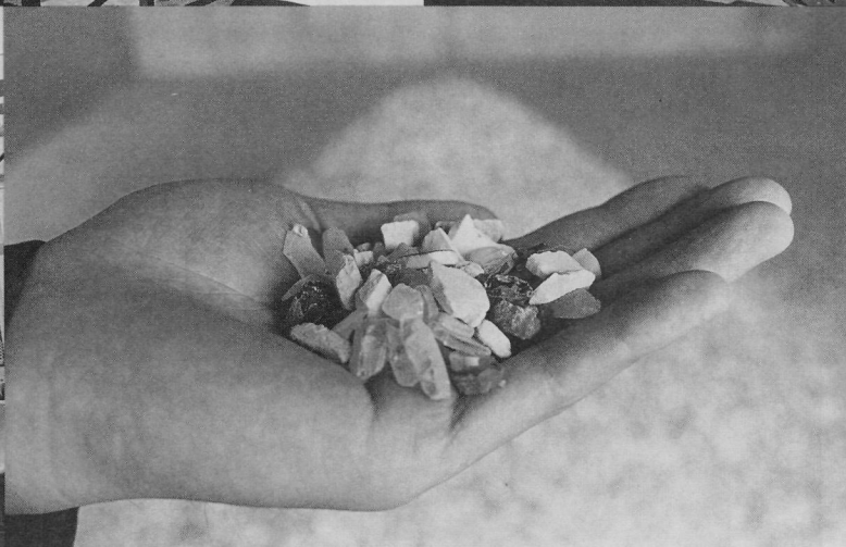
残渣から金属や不純物を取り除き、大きさの違った骨材が出来上がります
