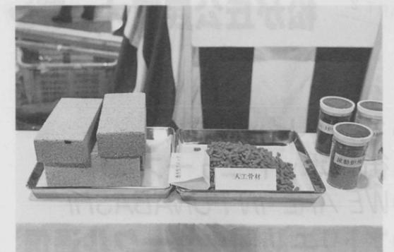
一次製品の人工骨材(右)と二次製品の透水性タイル
