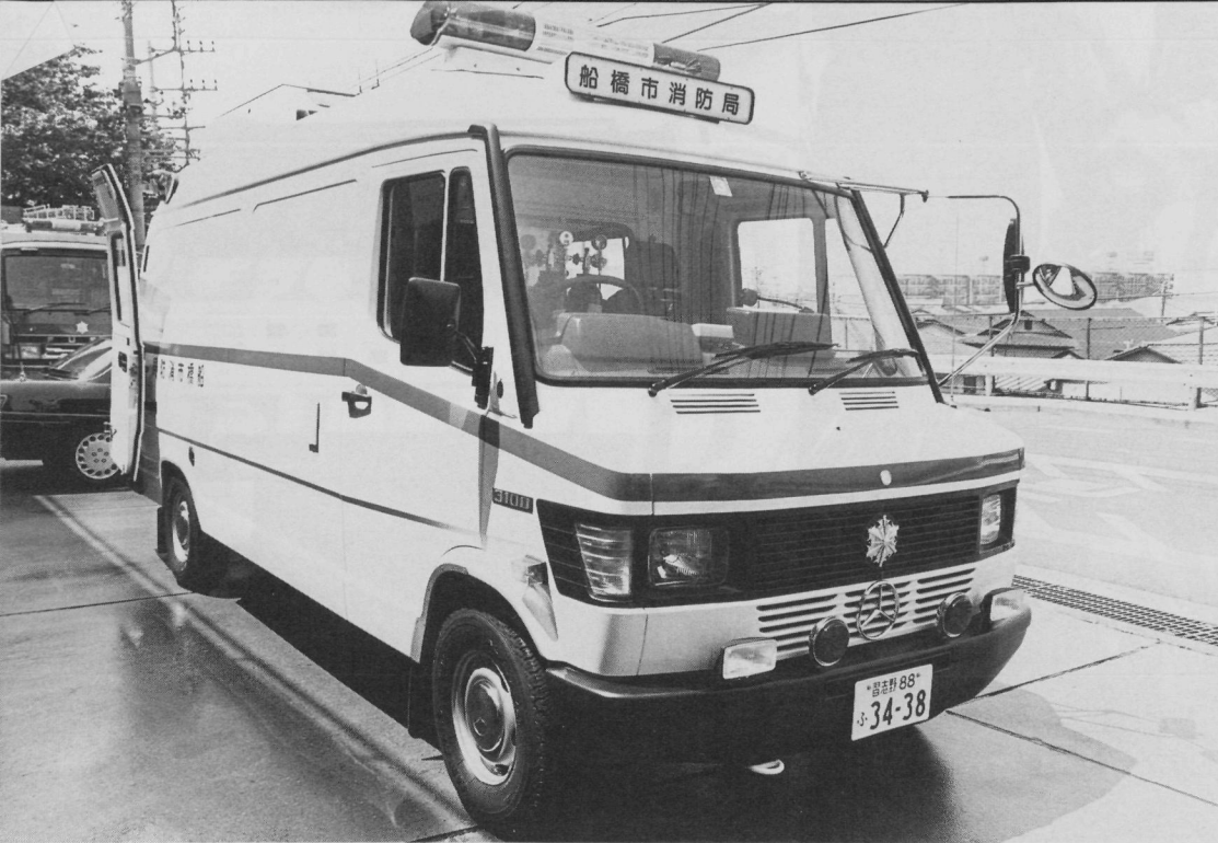
現行の救急車より大きいにもかかわらず運転しやすいという高規格救急車。最小回転半径も5.5メートルと小回りがきく
