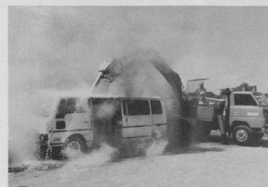
船橋市消防局が日本で初めて開発した破壊放水車「キツツキ号」。車両や家屋の壁を突き破って消火する
