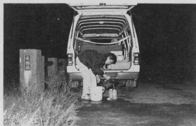
市環境保全課では、河川の汚染状況を監視するため、通常の水質検査に加えて、年4回、24時間の水質検査を行っている。近年の汚染状況は横ばいであった（金堀橋・午前1時）
