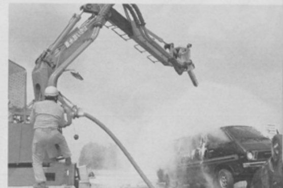
破壊放水車「きつつき号」は船橋市消防局が独自に開発した消防車だ。
