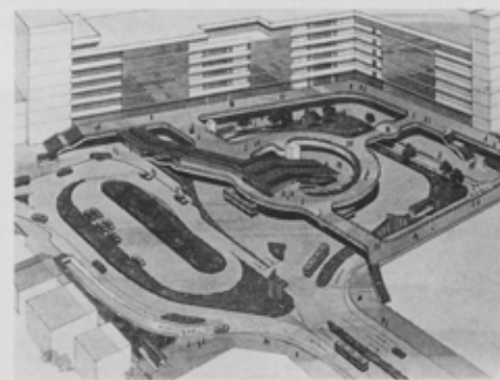
JR船橋駅北口完成予想図。工事が完成すると北口広場は、地下2階、1階、地上面、デッキ上と4層構造に生まれ変わります
