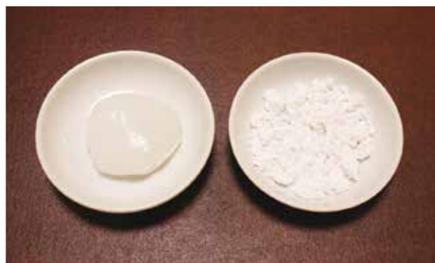
文化財修理に使用される代表的な接着剤（生麩糊） 右→原料（小麦粉澱粉） 左→水で炊いて作った糊 用途にあわせ、水で薄めて糊の濃度を変えながら使用する。
