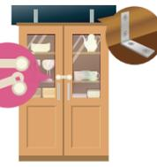
**食器棚は…**L字金具で固定する。ガラス飛散防止フィルムを貼る。扉開放防止器具を使う。すべりどめシートで食器の飛び出しを防止する。
