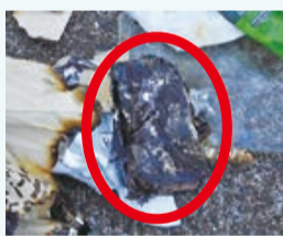
▲発火の原因とみられるモバイルバッテリー
