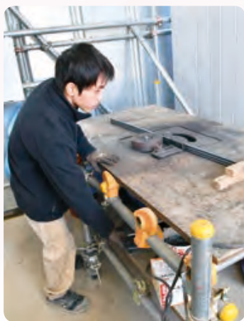
▲作業台の下にスイッチを付けることで、安全な操作が可能に
