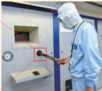
▲焙煎途中の豆をチェック。その日の気温や湿度で焙煎温度・時間を微調整します
