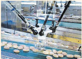
▲ロボットの腕が高速で商品をトレイ詰め
