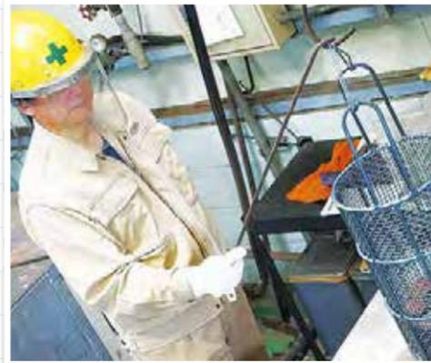
▲電気炉で加熱・冷却した後、さらに加熱を行い、基準片の硬さを調整します
