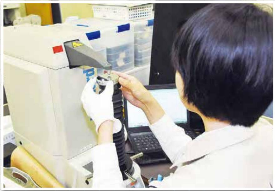
▲基準片に試験機でダイヤモンド圧子を押し当て、くぼみの深さを調べ、硬さを測定します
