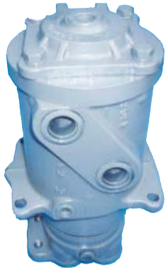
▲建設機械の旋回を支えるセンタージョイント(油圧部品)
