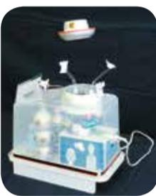
ドライヤーを使ってUFODを浮かせ、同時にプロペラの回転で発電。ペットボトル製のビル上部にあるLEDを点灯させるといったのもユニークな作品
