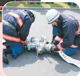
通常より太い100ミリホースを連結。最大約1キロ先までの遠距離送水が可能
