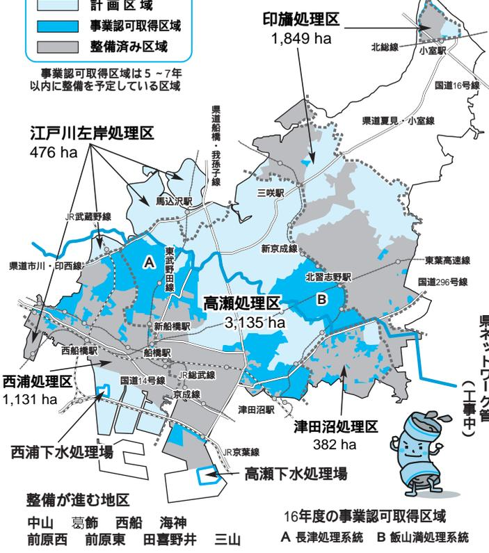
下水道は、各家庭から延びる枝管と、市内を走る幹線、汚水を浄化する処理場と成り立っています。市では、地域の約81パーセントにあたる6,973ヘクタールを下水道計画区域と定め、事業認可の取れた区域から、順次、整備を進めています。
