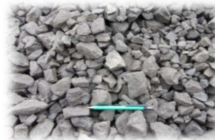
左図：灰を溶融させて作る人工碎石（溶融スラグ）
