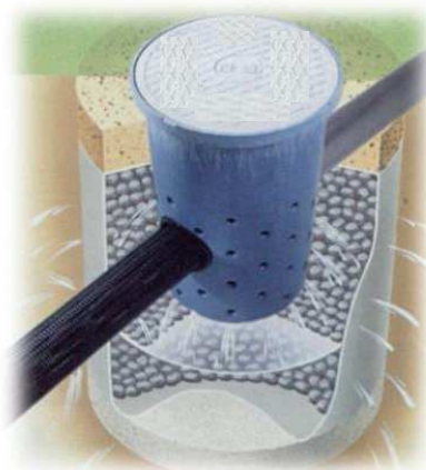
雨水浸透ます
