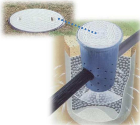
雨水浸透ます
