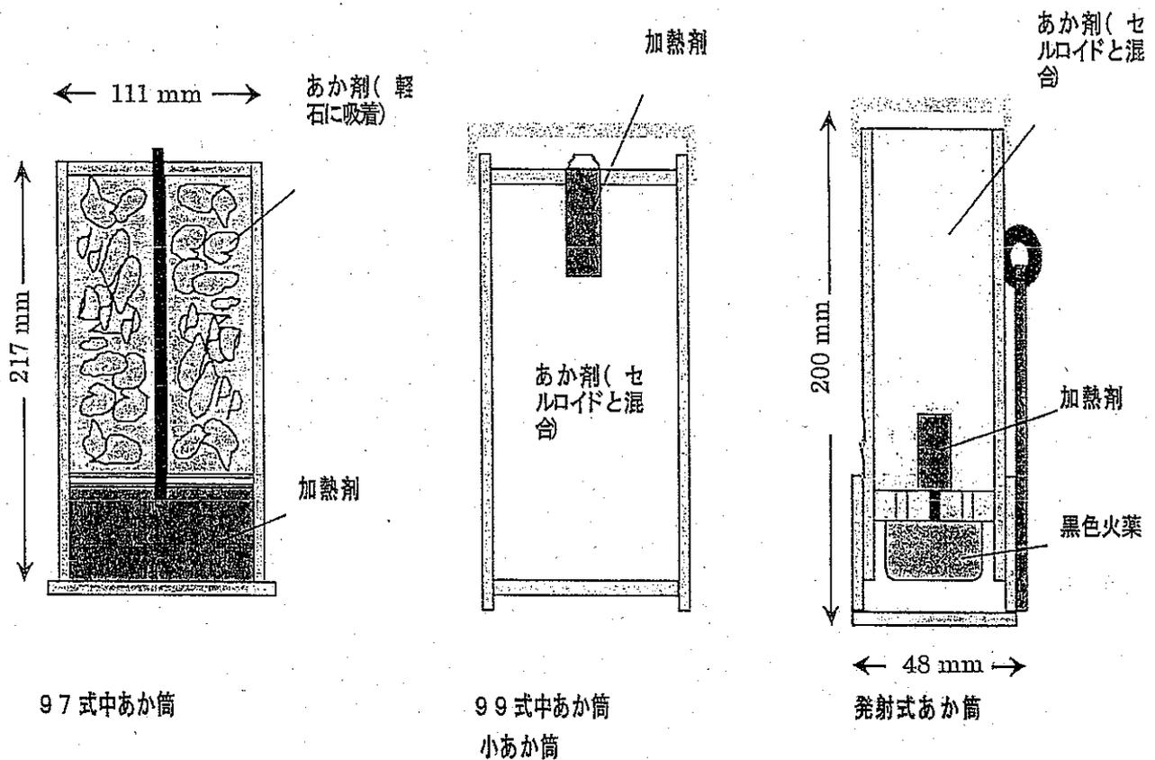
図3 有毒発煙管の断面図・添付
