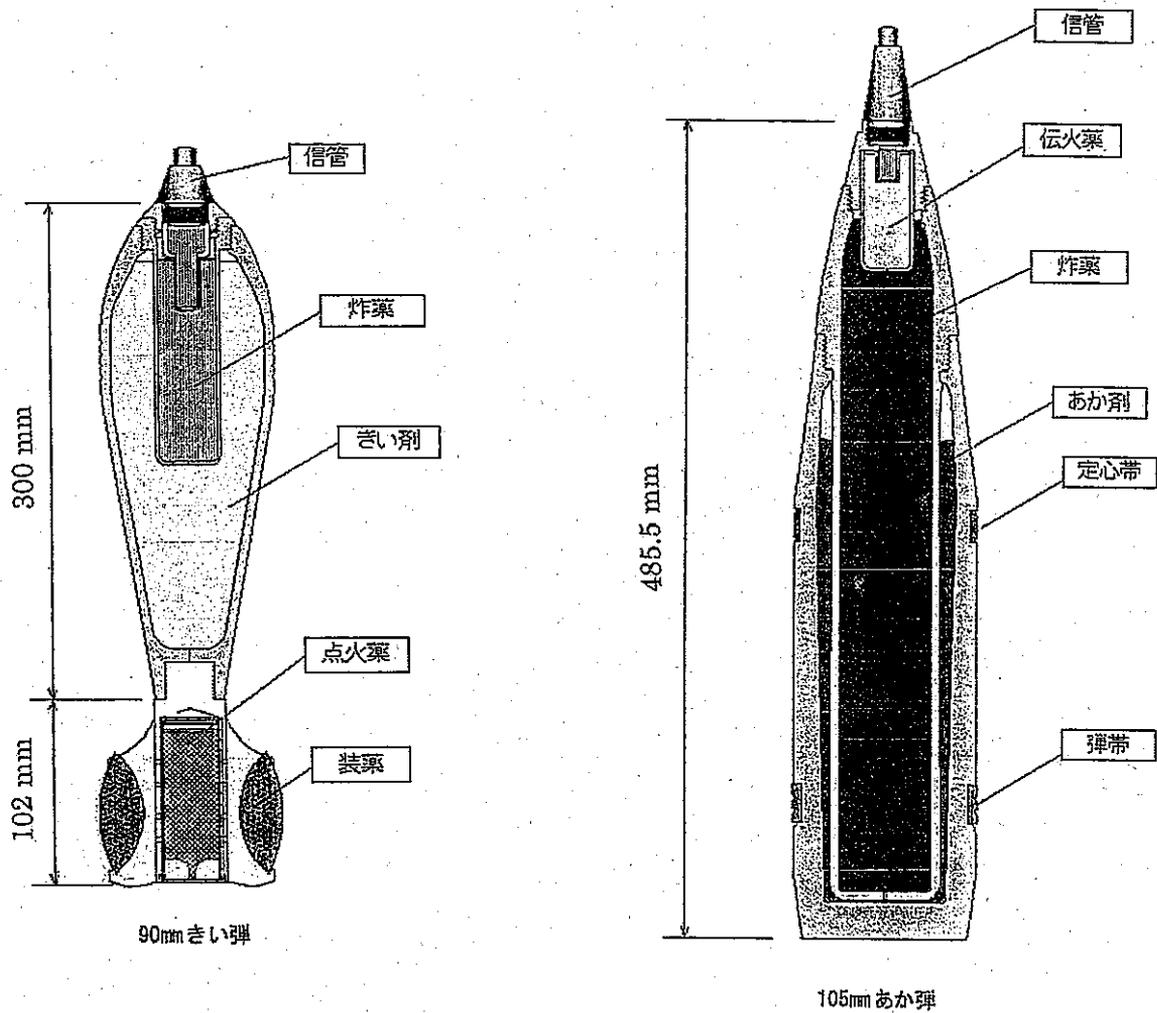
図1 砲弾の断面図・添付
