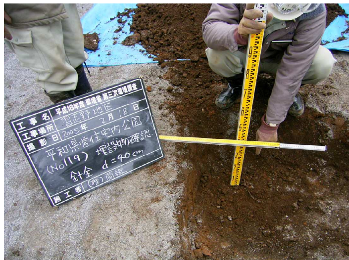
埋設物の例 針金 (深さ40cm、長さ約17cm、重量計0.04kg)
