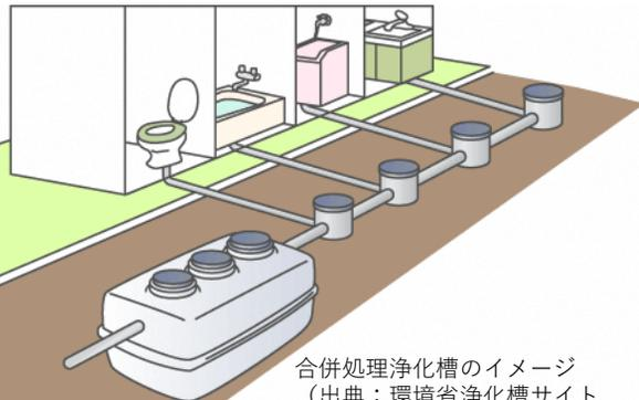
合併処理浄化槽のイメージ
