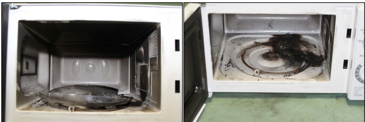
燃えた電子レンジ庫内の状態
