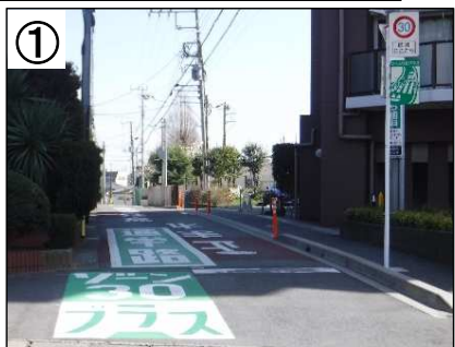
ゾーン30プラス看板・路面表示
