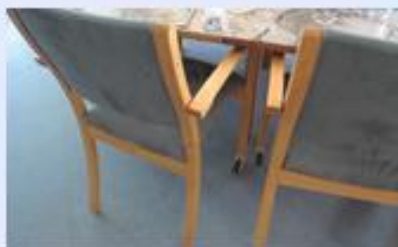
利用者を支える職員の負担を軽減させるために、椅子の前面に車輪を取り付けた。
