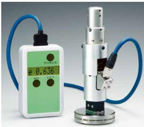
小さなセラミックス球を試料にぶつけると、衝突前後の球の速度の変化から、モノの硬さや反発係数が分かる。金属用の硬さ試験機として、従来の反発試験機は、重く大きな台座上に試料を固定しないと硬さが測定できなかった。これに対し、この試験機はそのような台座も不要で、小さなモノでも現場で簡単に測定できる（鉄鋼の場合、推奨最小試料：厚さ約 5mm、質量：25g）。しかも下向きはもちろん、上向きでも水平方向でも、全方向に自由に発射し硬さの測定が可能。
