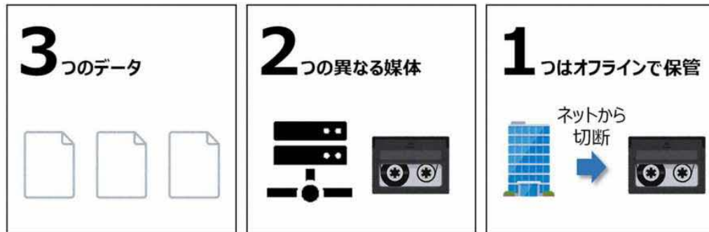
図 バックアップの321ルールを応用したランサムウェア対策の例
