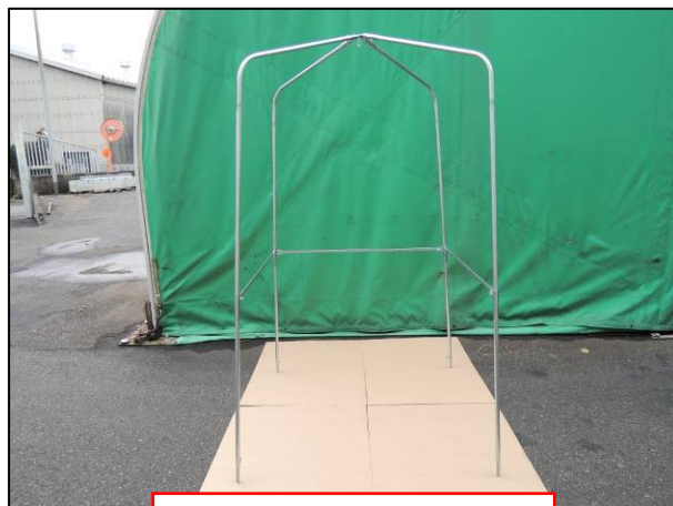
上部パイプを組み立てた状態
