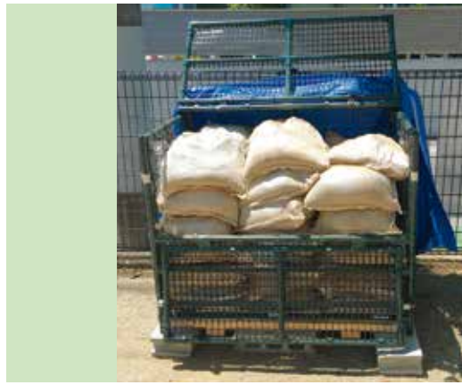
災害時に土のうを取り出せる、市川市の「地域型小規模土のうステーション」
