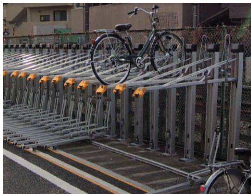
(2段式ラック駐輪場)
