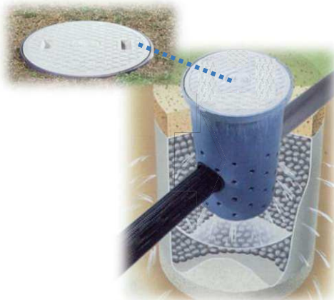
雨水浸透ます
