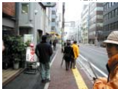
⑨国道 14 号南側は誘導用ブロックがあるが電柱が中央に立っていて危険
