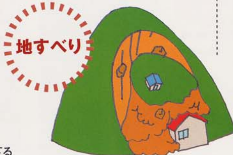
▲断続的に斜面が滑り出す
